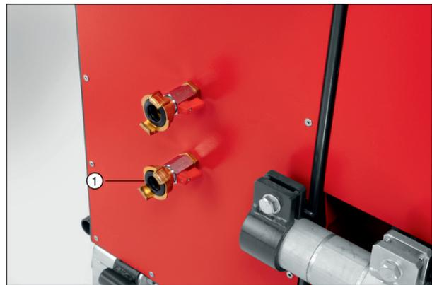
1. 凍結の危険がある場合 (< 4°C)、休憩時間の前、作業後、あるいは清掃の後には、モーターから冷却水を排出してください。
