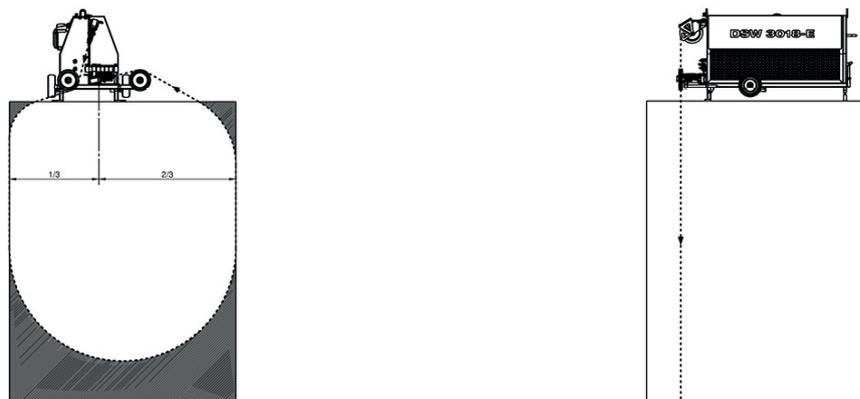
Corte con dispositivo de serrado vertical
