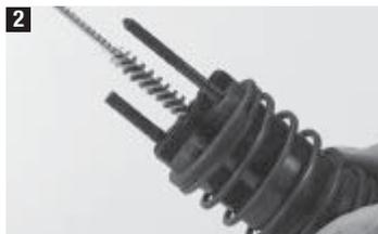
Avec le petit écouvillon, nettoyer les deux alésages qui se trouvent dans la face frontale de la chambre de combustion. Nettoyer l'intérieur du mécanisme de retour automatique du piston et lubrifier avec un peu de spray Hilti.
