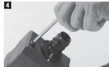
4 Dévisser les vis de serrage M6x30 d'environ 15 tours avec une clé pour vis à tête six pans creux.
