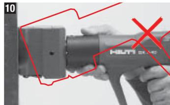
Pour réaliser le marquage, placer l'appareil bien perpendiculairement au support, l'appuyer et, alors seulement, presser la détente.
