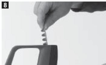
Introduire, dans le bas de la poignée, la bande-chargeur de cartouches par son extrémité étroite et la faire avancer jusqu'à ce qu'elle soit bien à ras de la poignée. Si des cartouches ont déjà été utilisées, tirer la bande à la main jusqu'à ce qu'une cartouche non encore utilisée se trouve dans la chambre de combustion.
