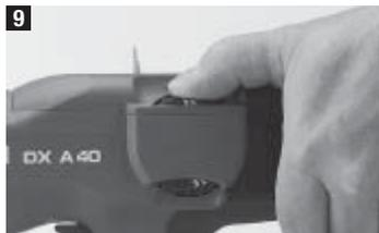
Pour régler la puissance de l'appareil, tourner la molette de réglage:
